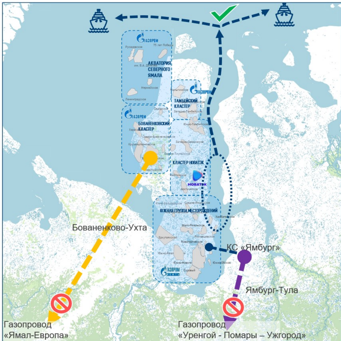
Рис. 2. Схема существующих транспортных каналов поставки природного газа на полуострове Ямал
